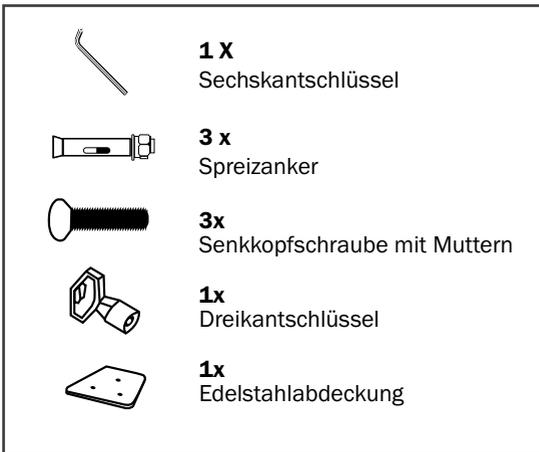
**1)** Sockel mit Hilfe des Sechskantschlüssels demontieren.
